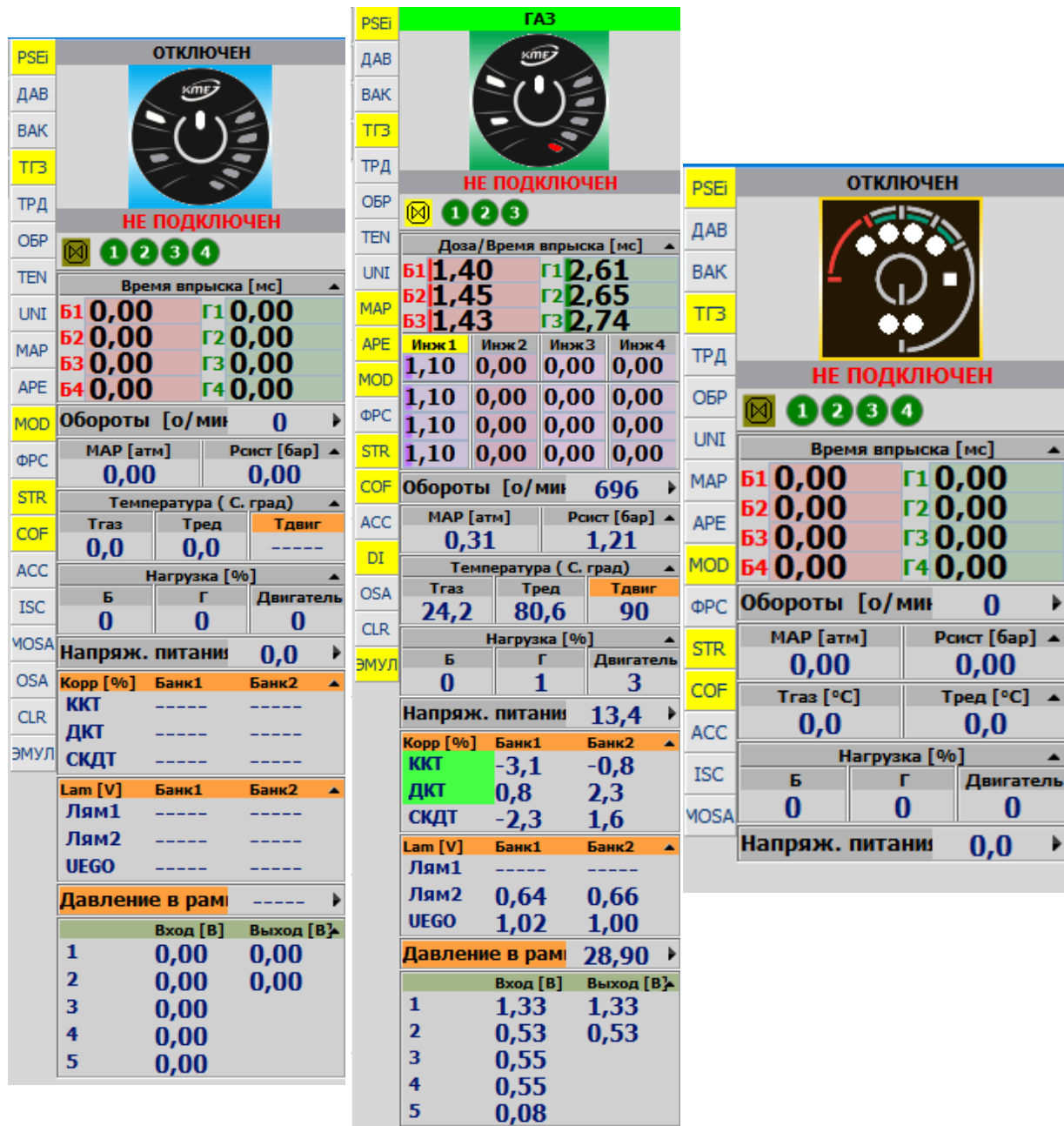
Рис. 2.2 Боковая панель считывания «FUNCTION», которая указывает на активность выбранных функций газового ЭБУ (слева направо MAX, DIRECT и SUN)
