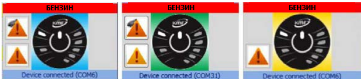
Рис. 2.7 Виртуальная панель со строкой состояния и треугольником, информирующим о регистрации ошибок газовым контроллером и OBD (MAX, DIRECT и SUN вид отличается цветом фона панели) и строкой состояния.
