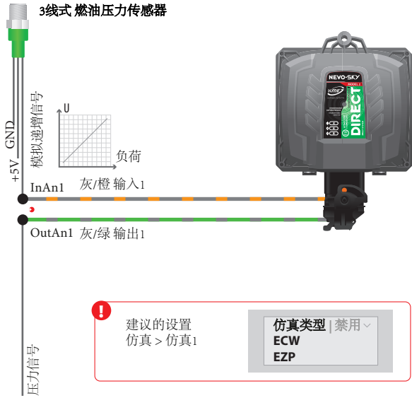
3线式 燃油压力传感器
